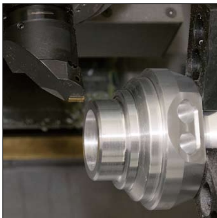
... usinage longitudinal avec un même outil ...
